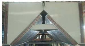
По сравнению с оборудованием кондиционирования предыдущего поколения конденсатор нового поколения имеет М-образную форму, что позволило увеличить площадь теплообмена и добиться большей компактности чиллера.
