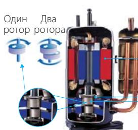
Устройство компрессора (двуихроторного)
